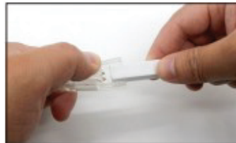
2. ต่อไฟเส้น LED เข้ากับหัวต่อ (connector) ให้แน่นสนิท
