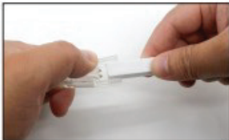
1. จัดวางไฟเส้น LED และอุปกรณ์หัวต่อ (connector) ในตำแหน่งที่ต้องการ
