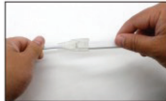
3. ไฟเส้น LED จะถูกล็อกไว้ เมื่อใส่หัวต่อ (connector) อีกตัวที่อยู่ด้านนอก และยึดติดด้วยกาวเพื่อประสิทธิภาพการป้องกันน้ำที่ดียิ่งขึ้น
